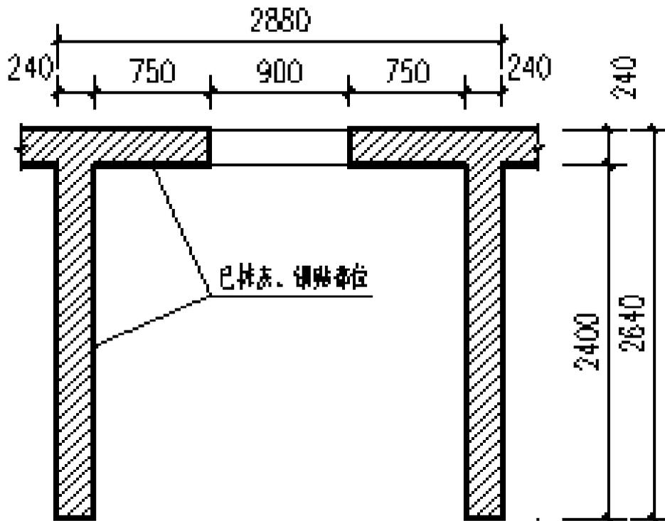
**抹灰、镶贴工程检测工位平面**
